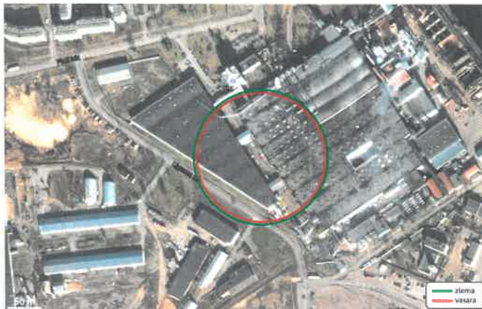
1.3.1.attēls. Sprādzienbīstamo koncentrāciju (2,1%) izplatības zonas noplūstot 6,7m 3 propānam no spiedvertnes vasaras naktī un ziemas dienā
