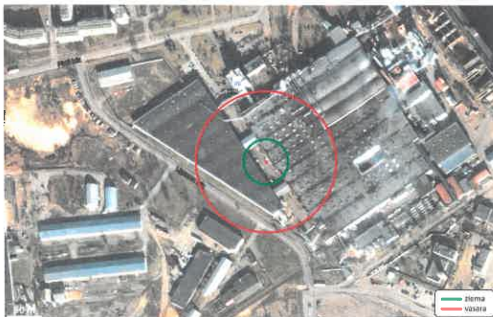
1.3.2.attēls. Sprādzienbīstamo koncentrāciju (1,8%) izplatības zonas noplūstot 6,7m 3 butānam no spiedvertnes vasaras naktī un ziemas dienā
