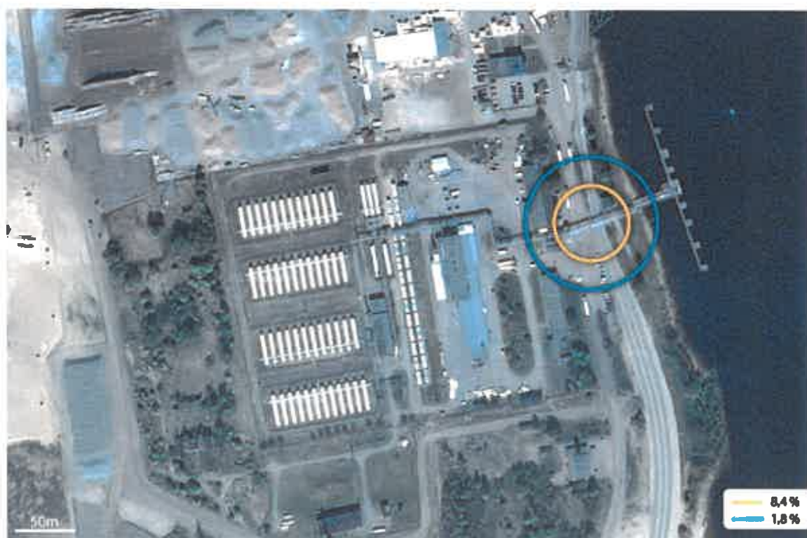
Sprādzienbīstamo koncentrāciju izplatība butānam noplūstot no maģistrālā cauruļvada ziemas dienā (vēja ātrums 1m/s)
