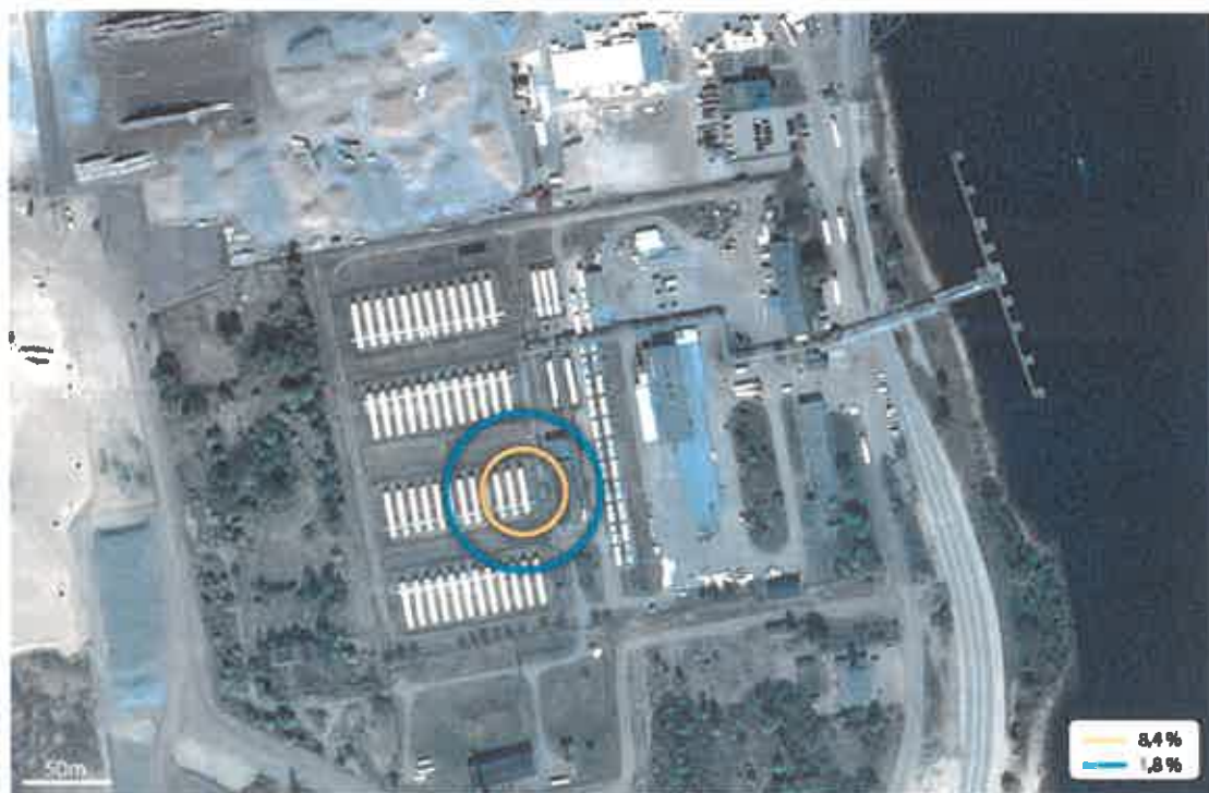
Sprādzienbīstamo koncentrāciju izplatība propānam daļēji noplūstot no 175m 3 spiedvertnes ziemas naktī (vēja ātrums 1m/s)
