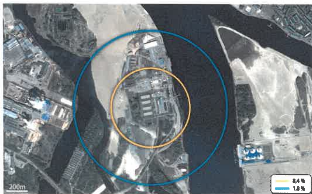
Sprādzienbīstamo koncentrāciju izplatība propānam noplūstot no 175m 3 spiedvertnes ziemas dienā (vēja ātrums 1m/s)
