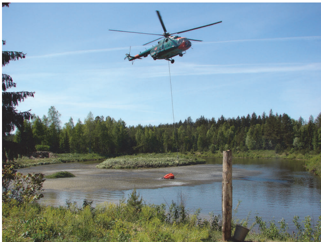
26. attēls. Ar Bambi Bucket 5566HD aprīkots helikopters Mi8-MTV. (foto J. Ozoliņš)
